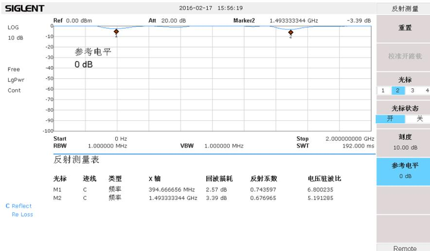
5)选择光标，光标状态-开，即可打开多个光标，移动光标位置，屏幕的下半部分会显示出该点的频率、回波损耗、反射系数和电压驻波比的测量结果；
